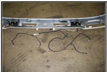
REMOVE WIRING HARNESS FROM ORIGINAL BUMPER BAR.
